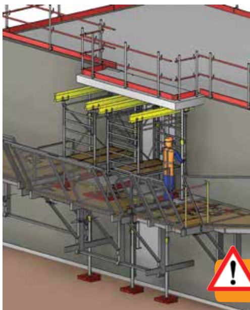
Fig. 21 • Décoffrage et pose des étais de séchage à l'avancement (sous-étauement).
