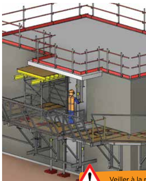
Fig. 15 • Décoffrage et pose des étais de séchage à l'avancement (sous-étaielement).
