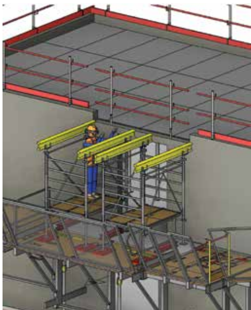
Fig. 17 • Mise en place de l'étaie.
